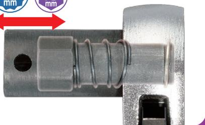
ソケット部は10mm・13mmのスライド式ダブルソケットを採用。一方向で2サイズ使える為、持ち替え不要で作業効率が格段にアップします。
