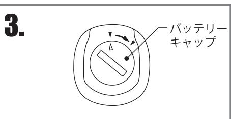
乾電池を挿入したら、バッテリーキャップと本体の矢印の位置を左図のように合わせてください。
