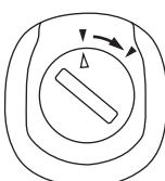
乾電池を挿入したら、バッテリーキャップと本体の矢印の位置を左図のように合わせてください。
