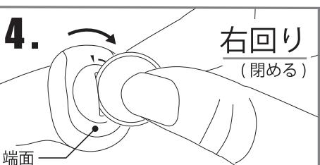
矢印の位置を合わせたら、コイン等をバッテリーキャップの溝に当て、バッテリーキャップが端面とツライチ以下になるまで強く押し当てながら右にゆっくり廻してください。
