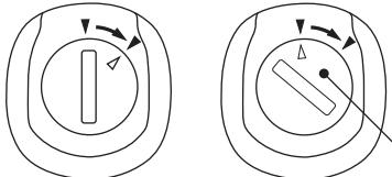
左図を参照し、バッテリーキャップの状態を確認してください。出荷時はバッテリーキャップは閉まっています。開いている場合は、そのままバッテリーキャップを外し、3.を参照し電池を挿入してください。
