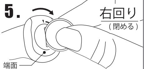
矢印の位置を合わせたら、コイン等をバッテリーキャップの溝に当て、バッテリーキャップが端面とツライチ以下になるまで強く押し当てながら右に廻してください。
